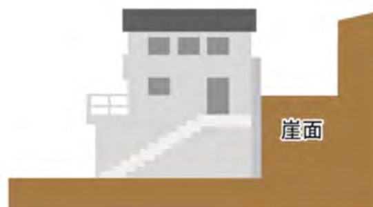
※参考図 建物の一部が擁壁を兼ねる場合
