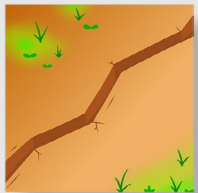
①斜面の亀裂
