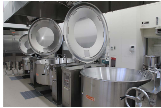
調理室 広さにゆとりのある調理室で、電気回転釜が3釜あり、その日のメインの献立（カレーや汁物）などが作られます。
